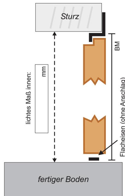
BM = Oberkante fertiger Boden - UK Sturz
