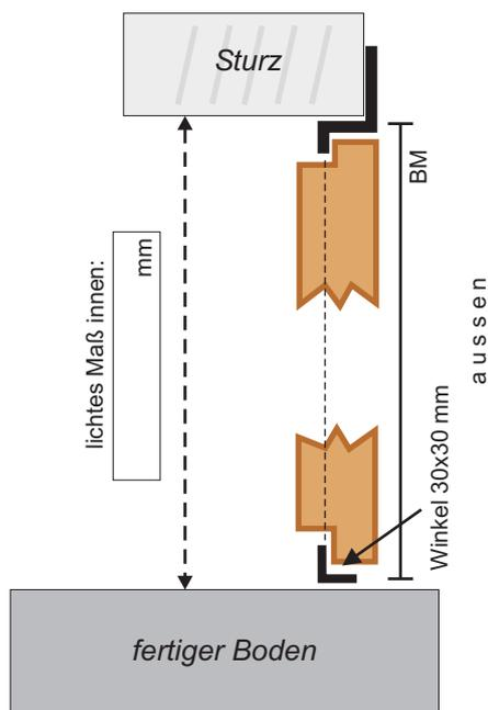
BM = Oberkante fertiger Boden - UK Sturz
