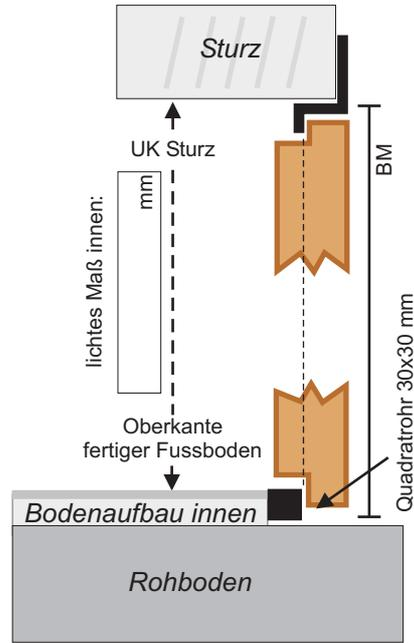
BM = Oberkante fertiger Fussboden - UK Sturz
